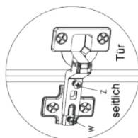
Wenn die montierte Schranktür beim Schließen falsch ausgerichtet ist, muss die Tür angepasst werden. Dies kann wie folgt geschehen: Schraube (W) leicht lösen. Durch Lösen oder Anziehen der Schraube (Z) kann das Scharnier justiert und die Tür richtig ausgerichtet werden. Wenn Sie mehr als ein Scharnier einstellen müssen, stellen Sie es bitte schrittweise ein, ein Scharnier nach dem anderen. Suchen Sie im Zweifeleinstfall professionelle Hilfe auf.
