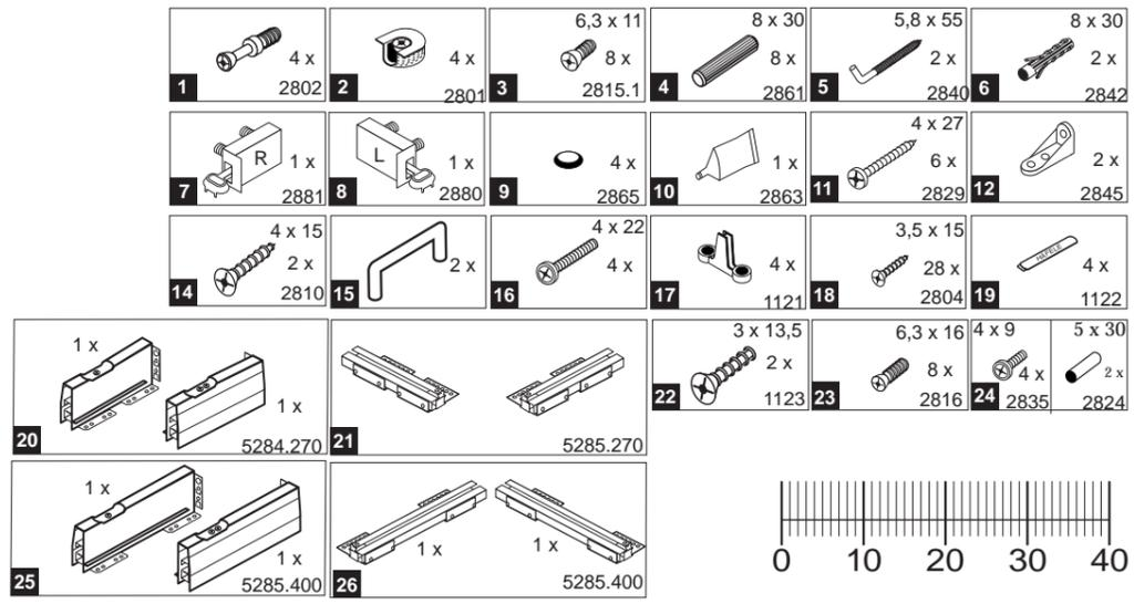
Das beigegefügte Wandbefestigungsmaterial (Dübel und Schrauben) eignet sich nur für festes Mauerwerk (z.B.: Beton- oder Ziegelwände). Für andere Wandaufbauten sind eventuell Spezialdübel und andere Schrauben notwendig. Ziehen Sie gegebenenfalls eine Fachkraft zu Rate.
